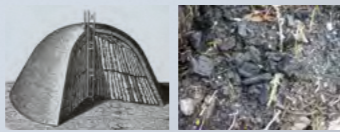
Die älteste Methode der Holzaufholzungsmethode ist der Malerbetrieb (Röhren). Der Mäler wird aus Holzschichten rund um einen Schacht sauber geschichtet und mit Erde, Gas und Moos luftdicht abgedeckt. Über dem Schacht wird der Mäler entzündet. Durch die Hitze des glimmenden Holzes verbrennen nur bei sorgsam geregelter Luftzufuhr nur die sich aus dem erhitzten Holz entwickelnden Gase und Dämpfe. Übrig bleibt Holzkohle.
