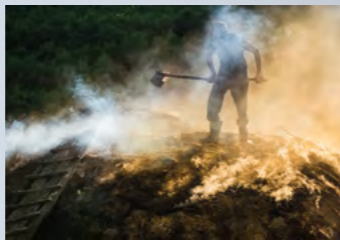
Die älteste Methode der Holzaufholzungsmethode ist der Malerbetrieb (Röhren). Der Mäler wird aus Holzschichten rund um einen Schacht sauber geschichtet und mit Erde, Gas und Moos luftdicht abgedeckt. Über dem Schacht wird der Mäler entzündet. Durch die Hitze des glimmenden Holzes verbrennen nur bei sorgsam geregelter Luftzufuhr nur die sich aus dem erhitzten Holz entwickelnden Gase und Dämpfe. Übrig bleibt Holzkohle.
